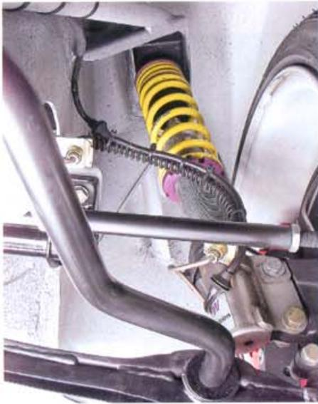
An den Seitenwänden wurden Federbeindome angesetzt, die ihre Stabilität aus der Überrollzelle beziehen.
